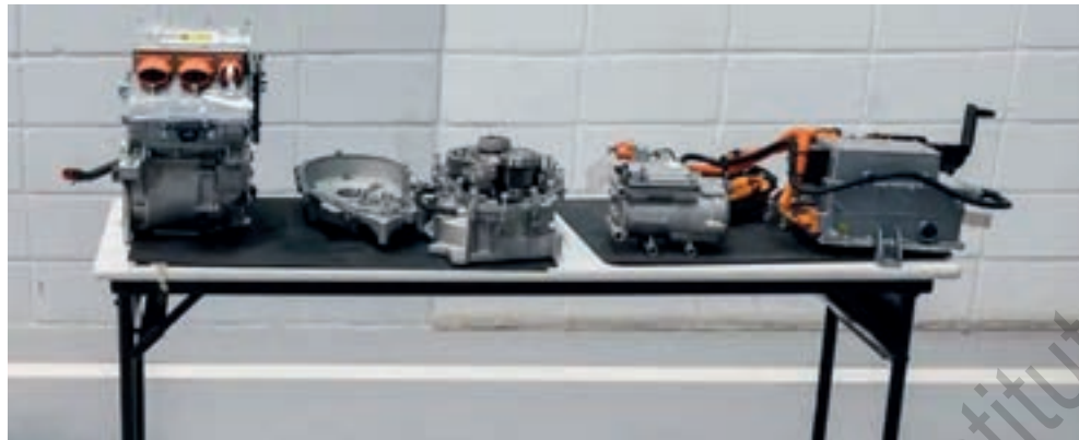
Componentes Elétricos (Motor e Sistema de AC) do Kwid E-Tech
